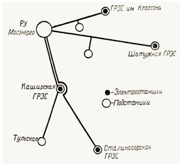
Электросвязь. Схема высокочастотных каналов связи по ЛЭП в 1941 г. Четыре действующих канала с одиннадцатью установленными постами
